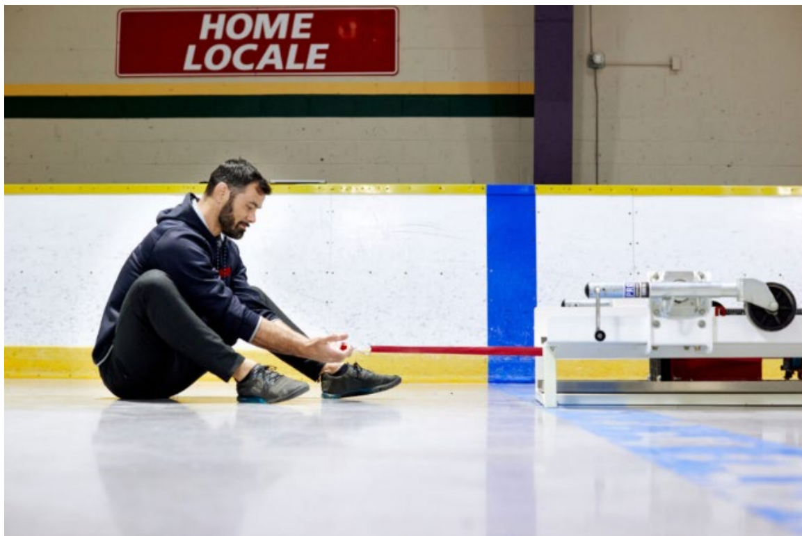
Figure 22 : Étalonnage du simulateur de piochage
