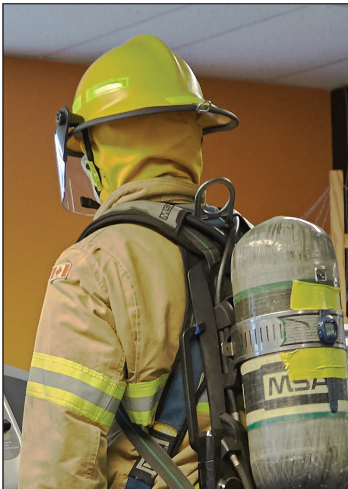
Figure 21 - Le joint annulaire visible au-dessus de l'APRIA
