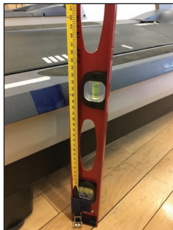
Figure 34 : Mesure de la hauteur à chaque extrémité de la distance de 1 m
