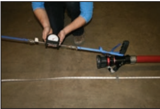
Figure 48 : lance fixée aux courroies et au tensiomètre, pour le Port du tuyau chargé
