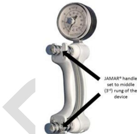
Figure XX : dynamomètre JAMAR et poignée de préhension
