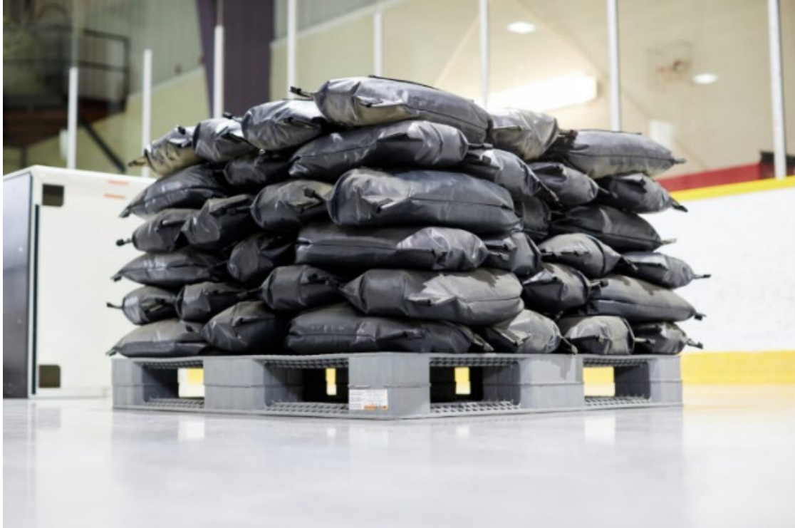
Figure 41 : Couches de sacs de sable en alternance
