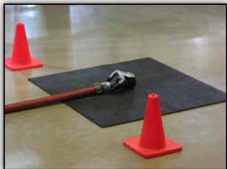
Figures 2-4 et 2-5. Vue d'ensemble de l'aménagement pour mesurer la force requise pour déplacer le tuyau chargé de 45 mm de diamètre sur une distance de 30,48 m (100 pi).
