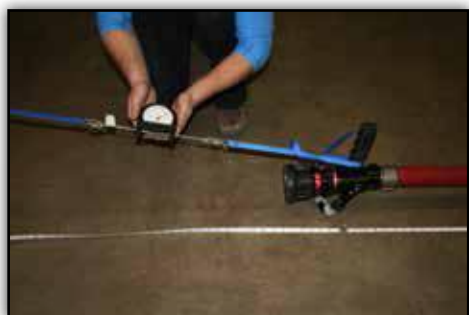
Figures 2-4 et 2-5. Vue d'ensemble de l'aménagement pour mesurer la force requise pour déplacer le tuyau chargé de 45 mm de diamètre sur une distance de 30,48 m (100 pi).
