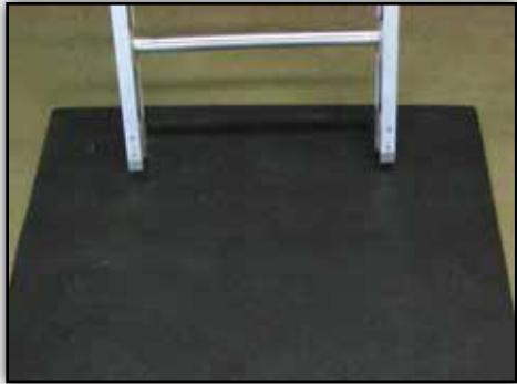
Figure 2-8. Pied de l'échelle sur un tapis antidérapant.
