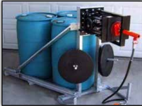
Figure B. L'appareil d'entrée par effraction greffé au châssis de fabrication commerciale disponible par l'entremise de CPAT Distribution, Inc. Ici, l'appareil est en cours d'étalonnage.
