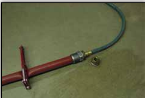
Figure 2-3. Mise sous pression d'un tuyau d'incendie à l'aide d'un tuyau d'arrosage. L'eau provient d'un robinet d'arrosage (ou du robinet d'une cuve de lavage) raccordé à un tuyau d'arrosage (de jardin). Le raccord est confectionné à l'aide de pièces de robinetterie vendues chez tout détaillant d'accessoires de plomberie. L'emploi de ruban Téflon sur tous les raccords et de colliers de serrage aide à prévenir les fuites.
