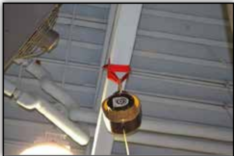
Figure 2-10. Descendeur autobloquant fixé au-dessus de l'échelle.
